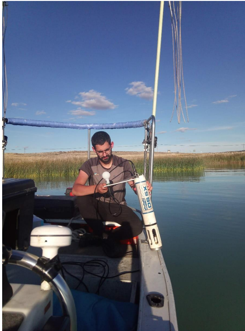
Figura 8. Operario preparado para realización de perfil vertical mediante sonda multiparamétrica
