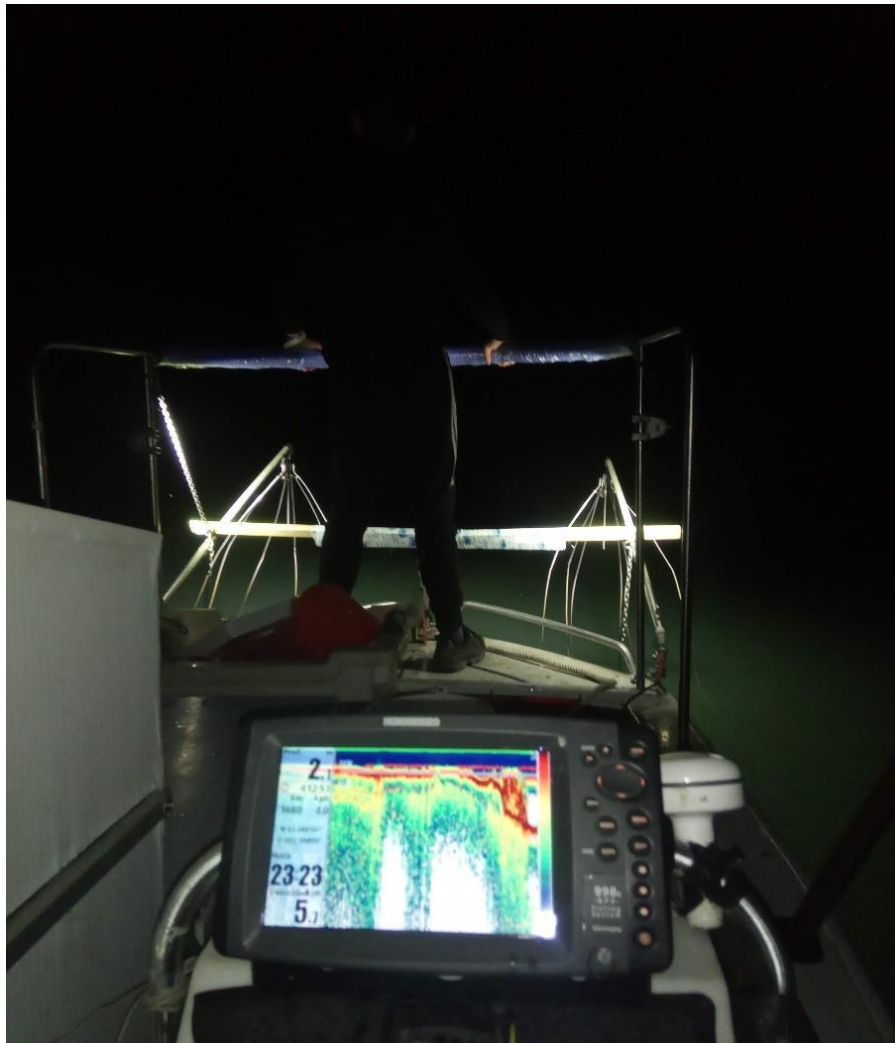
Figura 12. Pesca eléctrica desde embarcación en el embalse de Monteagudo
